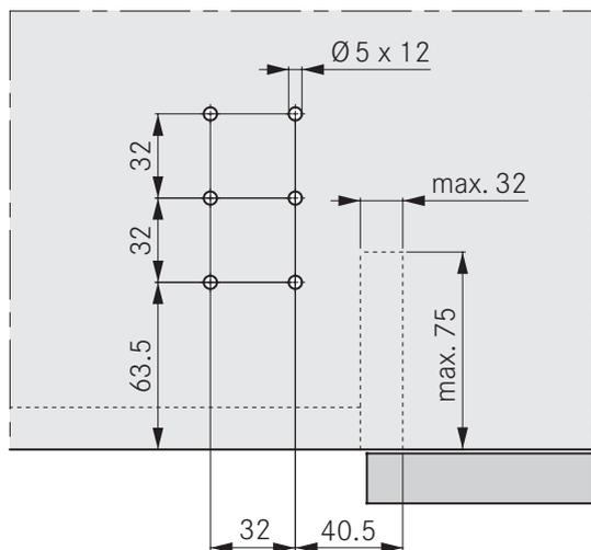
**Importante!** Realizar furações para fixação superior e inferior no módulo antes da montagem. Encaixe com parafusos de anel Euro com  $\varnothing 6,3 \times 10,5$ .
